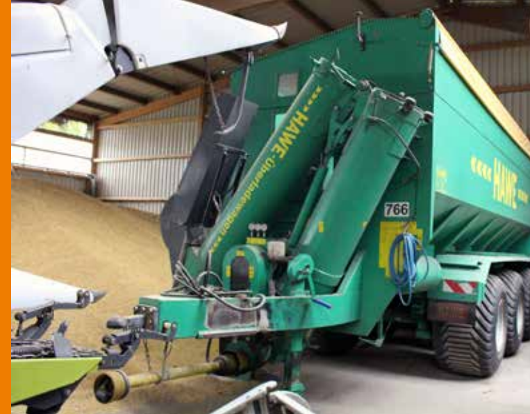
KS80-Kupplung mit Verschleißersatz an einem dreiachsigen Überladewagen (Quelle: igus GmbH)
